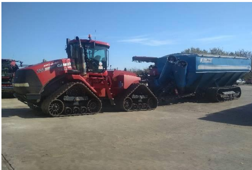
Рис.1.6. Бункер-перевантажувач Kinze-1500 в агрегаті з трактором Case IH 600 Quadtrack.
