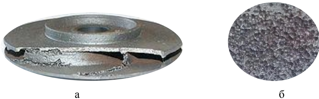
Рис. 1.15. Сліди кавітаційного зносу робочого колеса насоса
