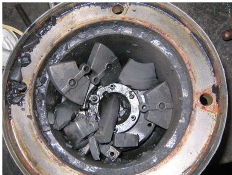
Рис. 1.16. Руйнування робочого колеса насоса
