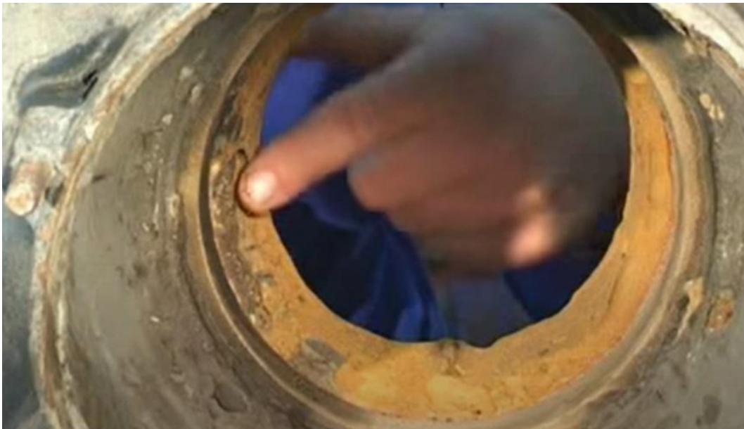
Рис. 1.19. Кавітаційний знос равлика насоса
