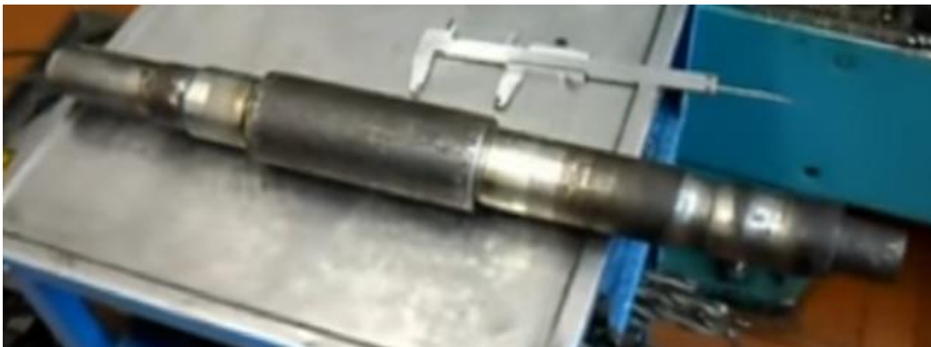
Рис. 1.14. Дефекти валу насосу
