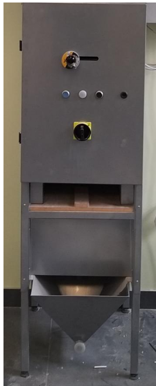
Рис. 1.5. Автоматичний дільник проби BioPro RODE 2
