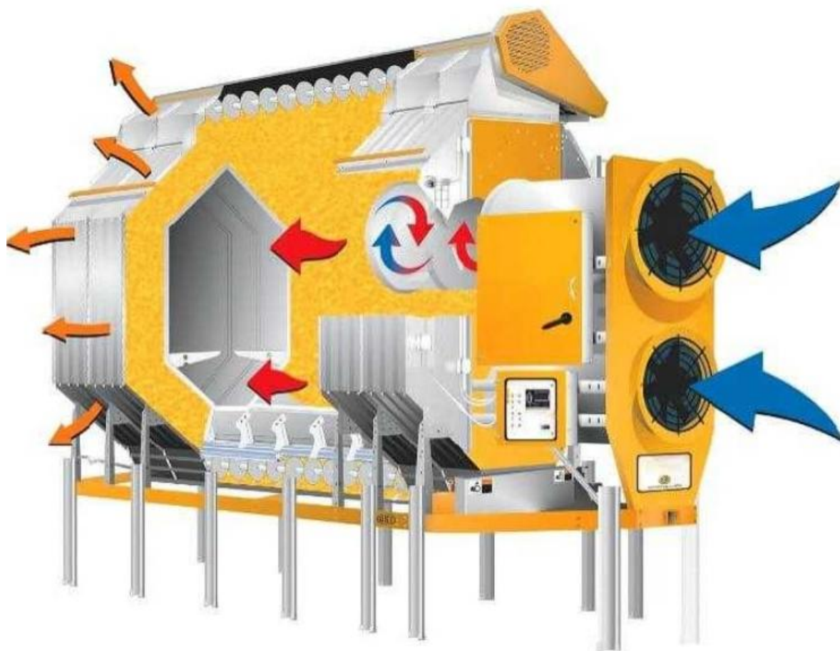
Рис. 3.3. Модульний горизонтальний тип зерносушарки.
