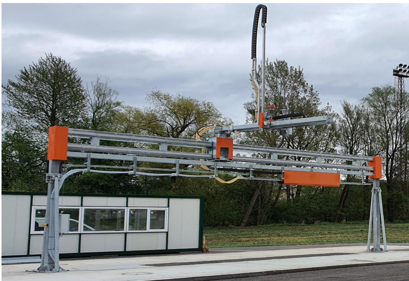
Рис. 1.4. Автоматичний пробовідбірник для вагонів BioPro Portal.
