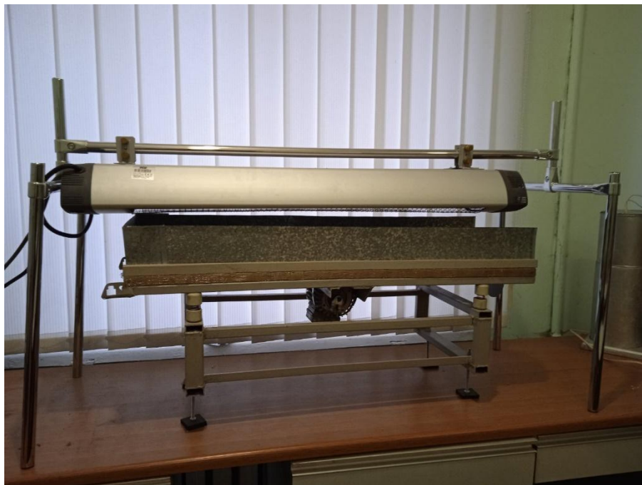
Рисунок 2.1. – Лабораторна установка мікронізатора з нерухомим шаром зерна
