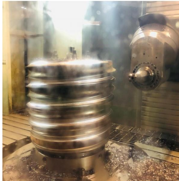
Рис.1. Загальний вигляд відновленого валка шаропрокатного стану
