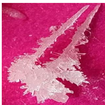
Рисунок 8 – Зовнішній вигляд кристалу \text{CaSO}_4 \cdot 2\text{H}_2\text{O} з полікарбоксилатною добавкою.
