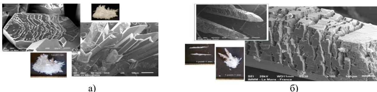
Рис. 2. – Кристали гіпсу, вирощені з добавкою: а) – Master X-Seed 100; б) Sika.
