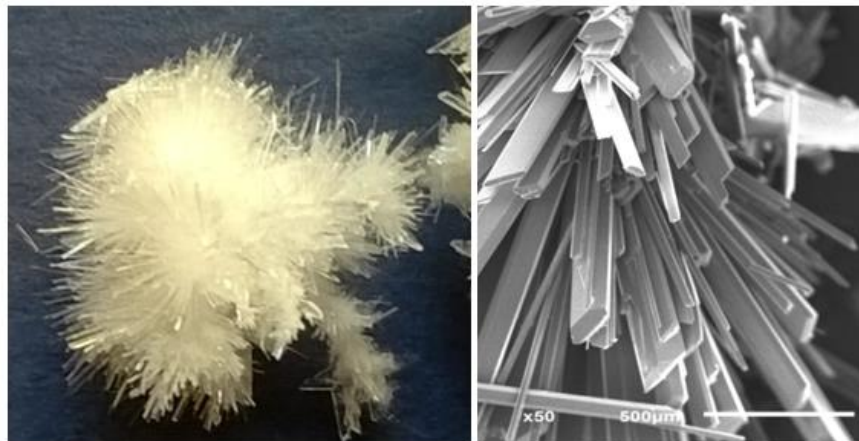
Рисунок 5 – Мікрофотографії кристалів одержаних методом зустрічного вирощування на основі \text{CaCl}_2 , \text{Na}_2\text{SO}_4 , 2\text{H}_2\text{O} .
