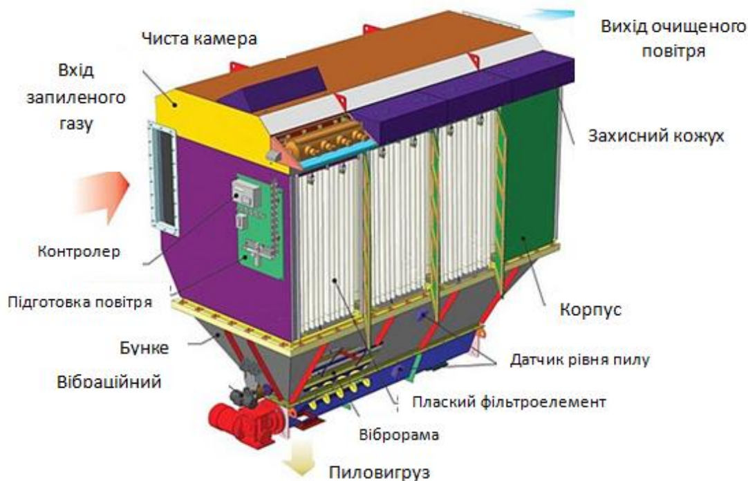
Рис.1. 3D-модель електричного фільтра сухого типу
