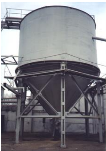
Відстійник-флотатор діаметром 7,2 м
