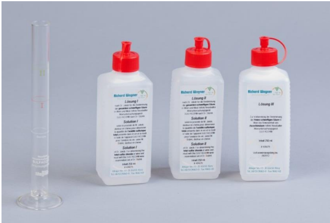
Рис. 3. «Нойштедтер» циліндр для змішування та розчини згідно методології доктора Штюрка (Dr. Stüthk)
