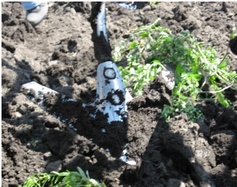
Рисунок 4.10 - Залипання ґрунтом стандартних культиваторних лап
