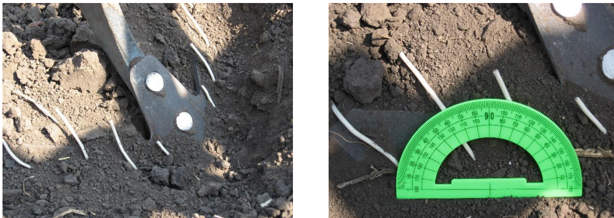
Рисунок 3.5 - Робочий момент визначення кута вступу ґрунту
