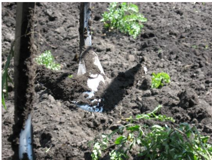
Рисунок 4.11 - Залипання ґрунтом культиваторних лап оснащених елементами локального зміцнення
