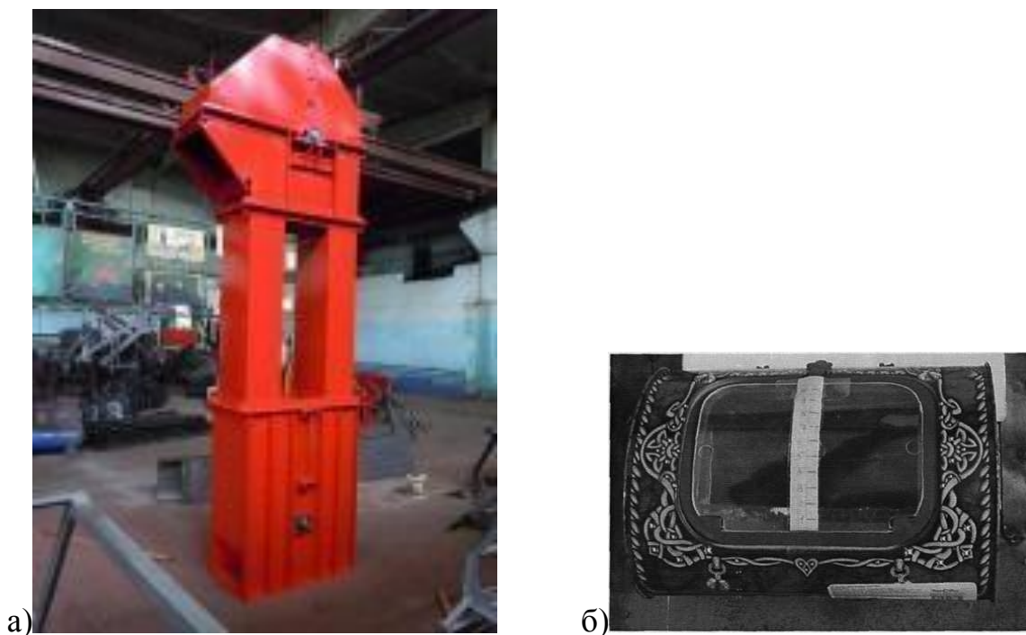
Рисунок 3.3 - Макетний зразок лабораторної установки: а) норія з вікном для установки пристрою для відбору проб зерна пасивної дії; б) пристрій для відбору проб зерна пасивної дії
