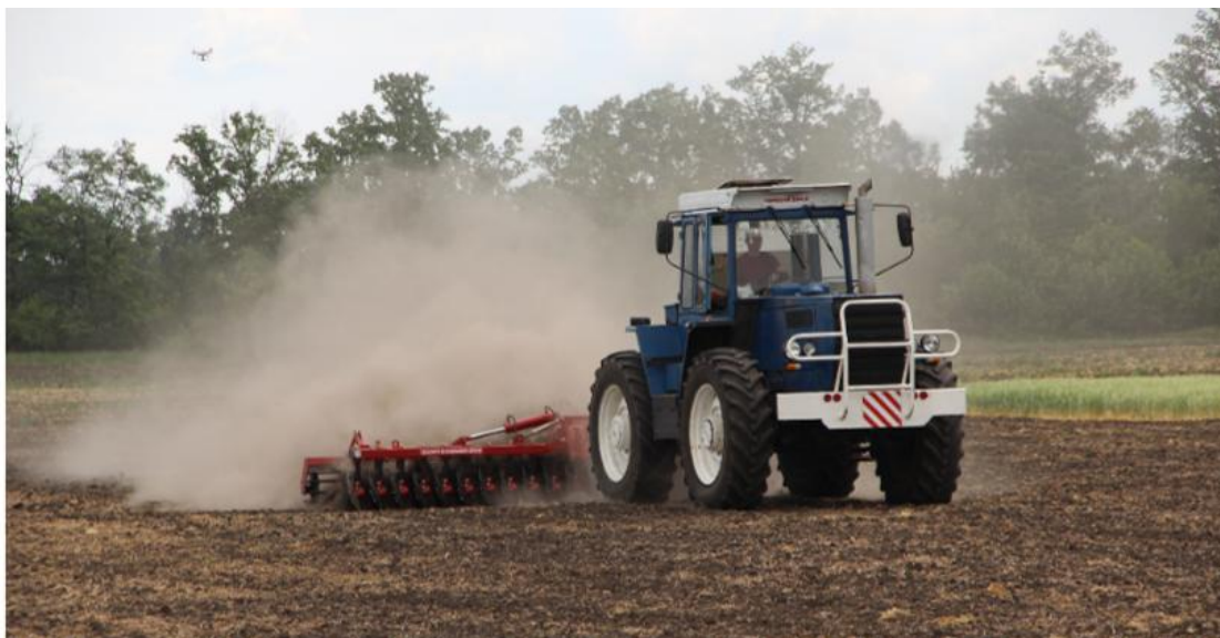
Рис.1.5. Дисковий агрегат, шириною захвату 6 м має перекриття на рівні 40...55 см.
