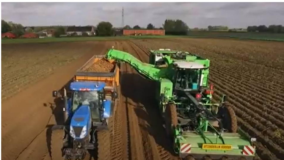
Рис.4.1. Збирання картоплі поточним методом: навантаження здійснюється на ходу, а агрегати йдуть по лініях навігації.
