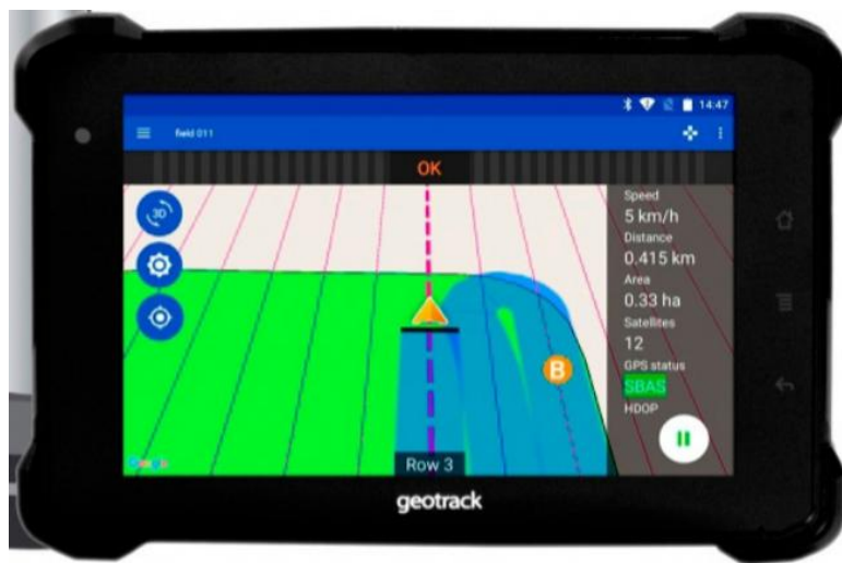
Рис. 3.1. Створення ліній паралельного водіння обладнанням ГеоТрек EVO 8.
