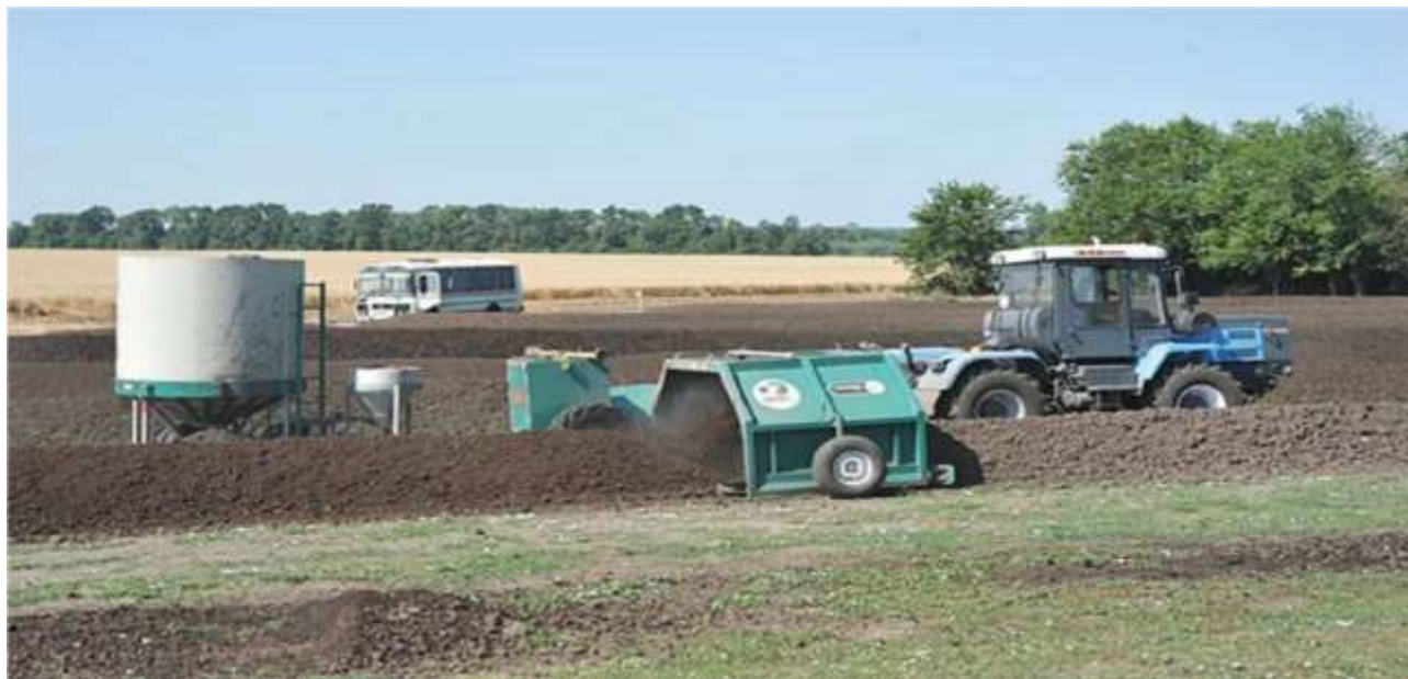
Рис. 1. Виготовлення органічного добрива методом пришвидшеної біологічної ферментації за допомогою аератора-змішувача у ТзОВ «Агрофірма Колос», с. Пустоварівка, Сквирського району, Київської області
