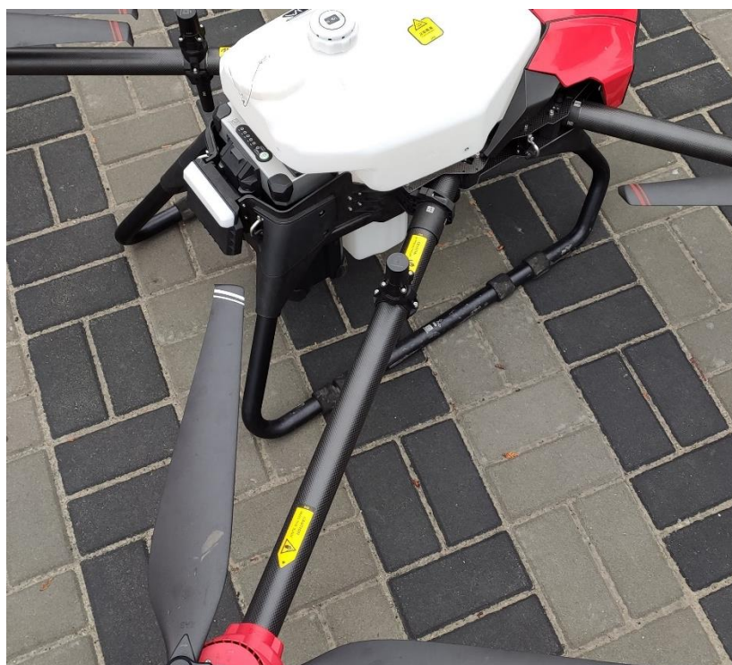
Рис. 1.27 – Важкий коптер з рамою, виготовленою з ПКМ на основі вуглецевої тканини
