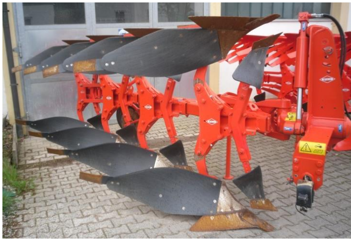
Рис. 1.19 – Плуг оборотний фірми Kuhn, оснащений полімерними відвалами
