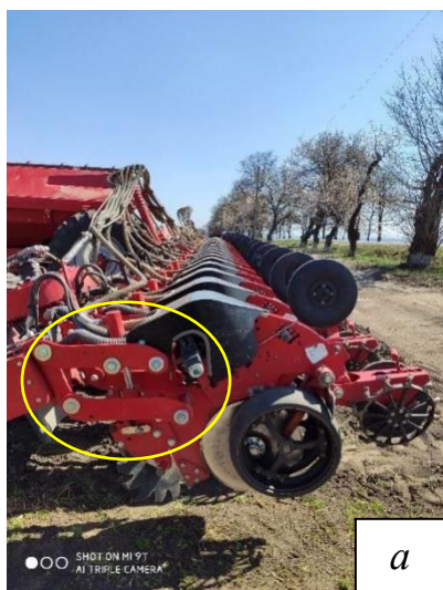
Рис. 1.16 – Паралелограмний механізм (а) та точки змащування на механізмі прикотних коліс (б) посівного комплексу Horsch Maestro 36.50 SW
