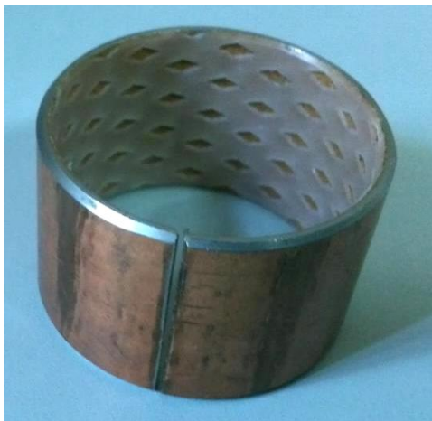
Рис. 1.24 – Серійна бронзова втулка вала розтискного кулака автомобіля КамАЗ-5320 з антифрикційною поліамідною сіткою
