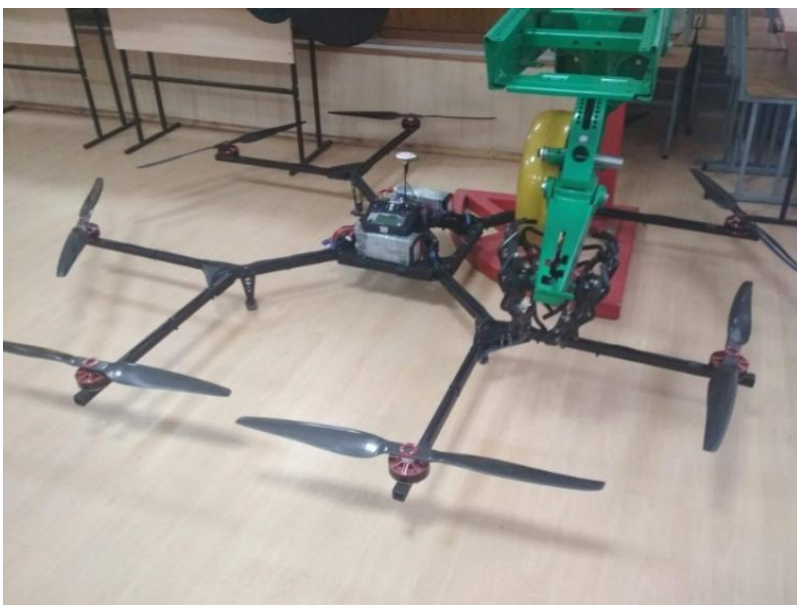
Рис. 1.26 – Важкий коптер, вантажопійомністю 26 кг, пропелери якого виготовлені з ПКМ
