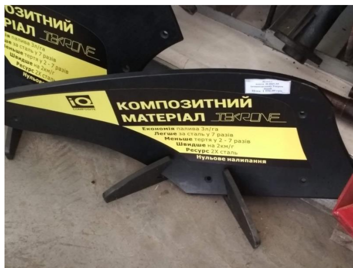
Рис. 1.20 – Відвал плуга, виготовлений з високомолекулярної сполуки Tekrone
