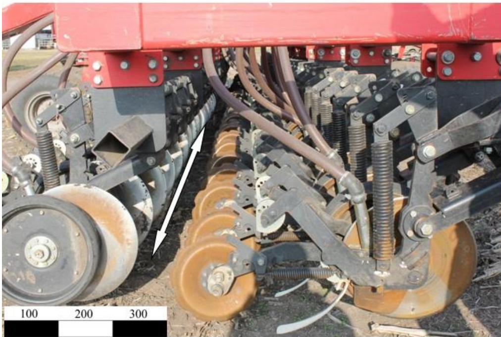
Рис. 1.11 – Розміщення посівних секцій на рамі посівного комплексу «Агро-Союз Turbosem II 19-60» (стрілкою вказано простір для проведення технічного обслуговування рухомих з'єднань переднього ряду сошників)
