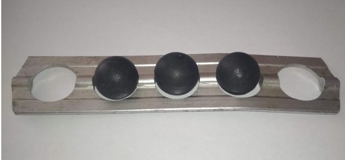
Рис. 4.7 – Секція поворотного механізму башти бойової машини з ПКМ-кульками. Експериментальний варіант
