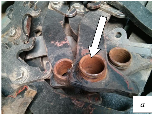
Рис. 1.13 – Наявність корозійної маси (а) в рухомому з'єднанні і дефекти (б), виявлені під час розбирання серійного вузла
