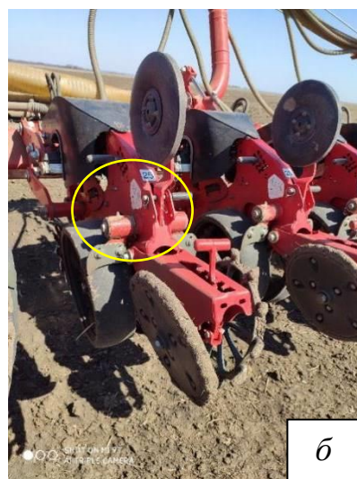
Рис. 1.16 – Паралелограмний механізм (а) та точки змащування на механізмі прикотних коліс (б) посівного комплексу Horsch Maestro 36.50 SW
