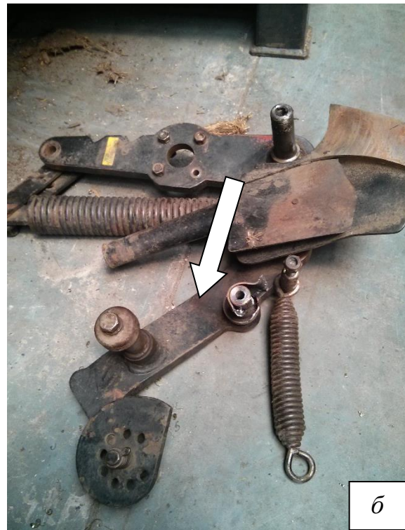
Рис. 1.13 – Наявність корозійної маси (а) в рухомому з'єднанні і дефекти (б), виявлені під час розбирання серійного вузла
