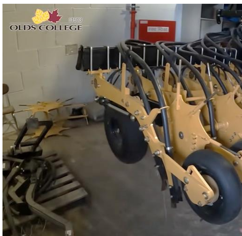
Рис. 4.4 – Посівна секція платформи Raven Autonomous Platform виконана традиційними методами машинобудування
