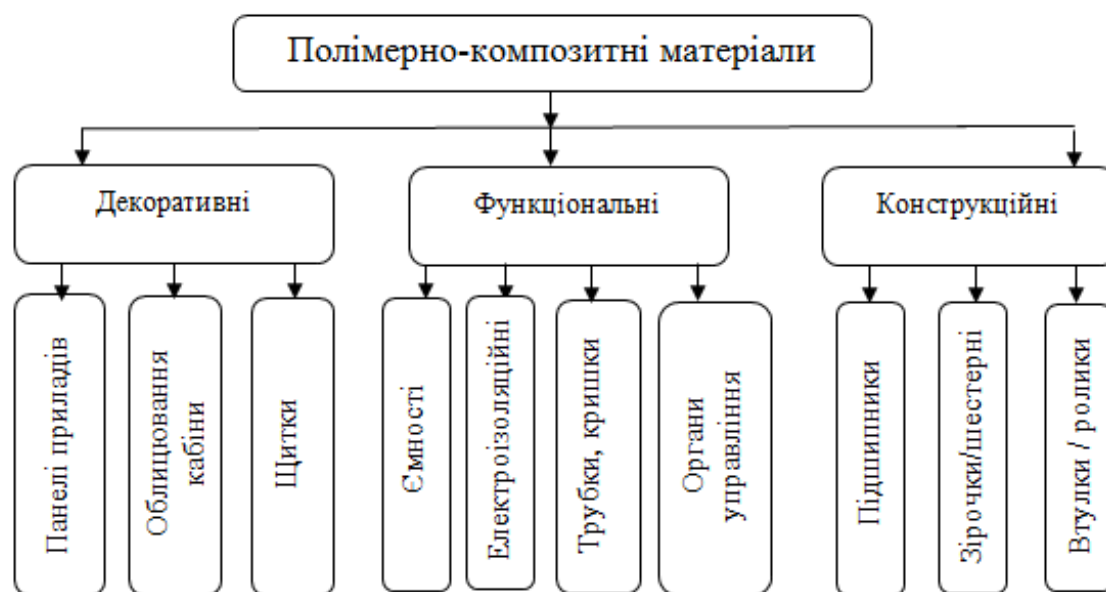
Рис. 1.1 – Спрощена класифікація полімерно-композитних матеріалів, із зазначенням конкретного їх застосування у сільськогосподарському машинобудуванні
