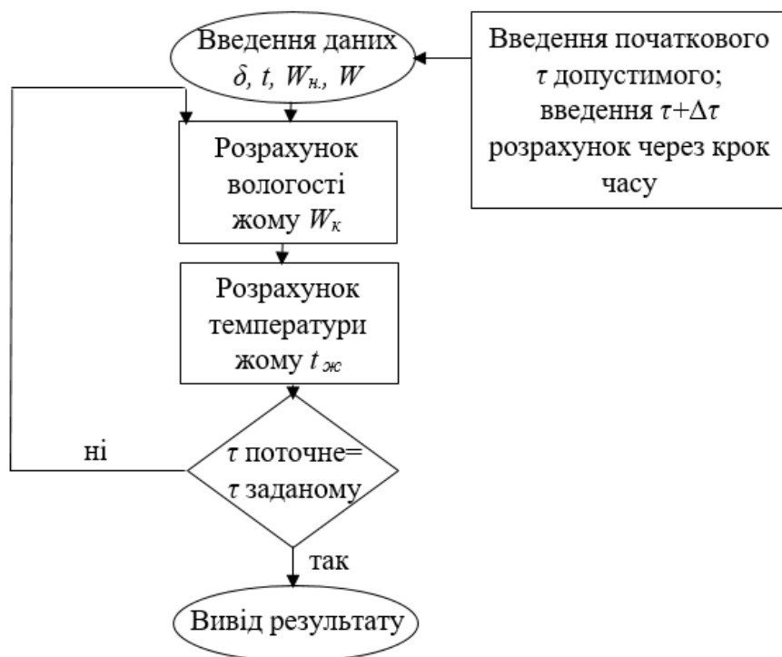
Рис. 1.16. Блок-схема алгоритму процесу досушування жому в шарі.
