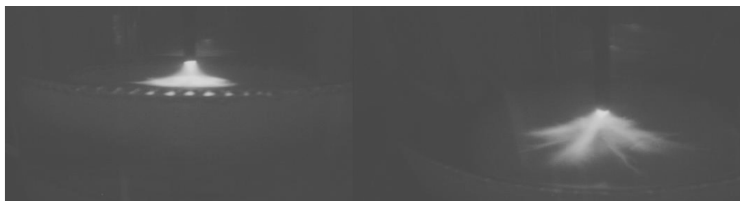
Рис. 2.10. Розряд за сталого режиму. Вид під кутом 10^\circ до поверхні рідини. Вид під кутом 45^\circ до поверхні рідини
