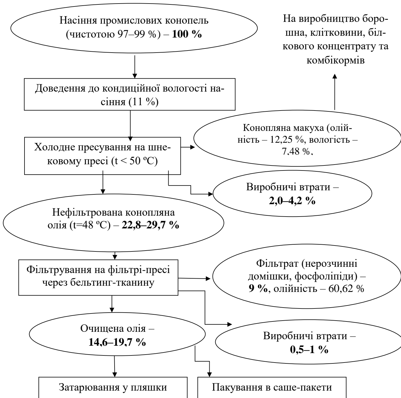
Рис. 7.14. Структурна схема виробництва олії конопляної
