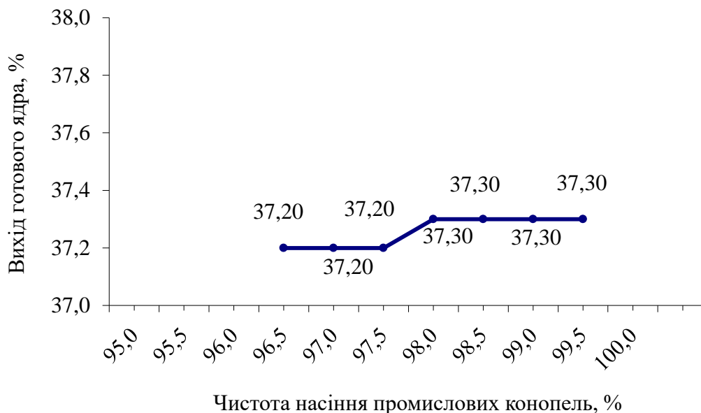
Рис. 7.7. Залежність виходу обрешеного насіння конопель від чистоти сировини
