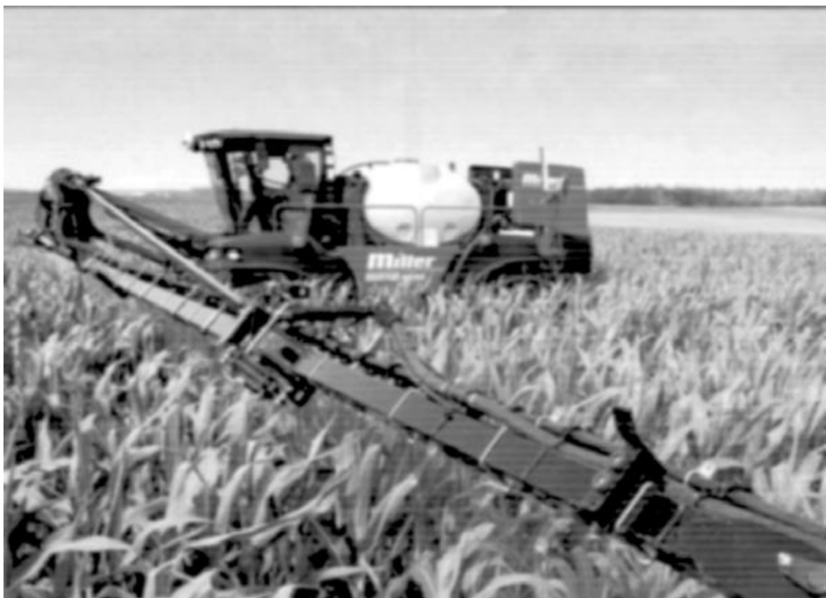
Рис. 47. Легка передня штанга обприскувача Miller Nitro 4240 швидко складатиметься на ходу перед розворотом уздовж лісосмуги і так же швидко розвертається
