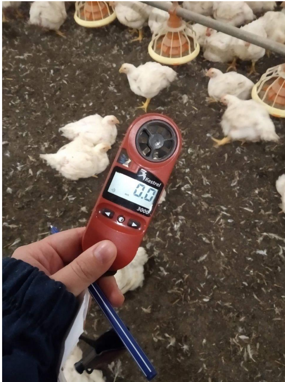
Рис .6. Прилад для вимірювання швидкості руху повітря у пташнику
