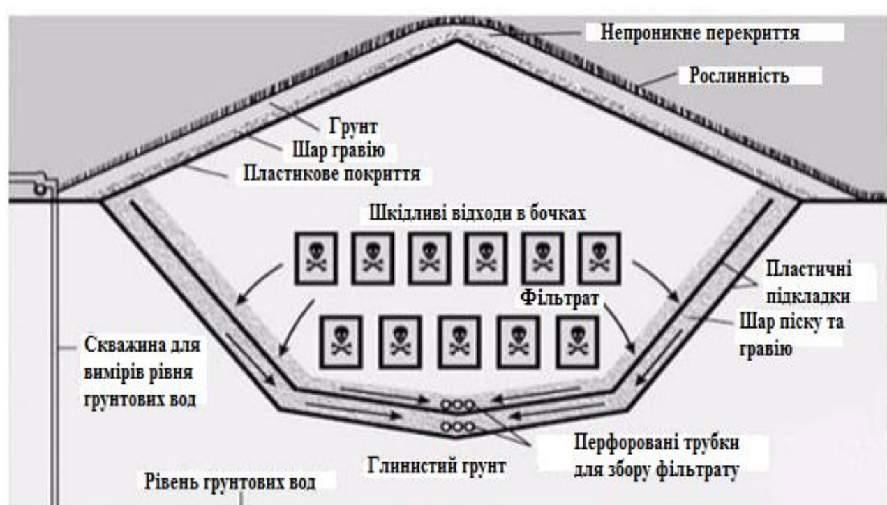
Рис. 1.8. – Влаштування полігону для зберігання небезпечних промислових відходів
