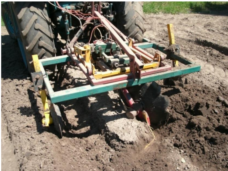
Рисунок 4.5. Тензометрична установка з сферично-дисковим робочим органом та підрізною лапою.
