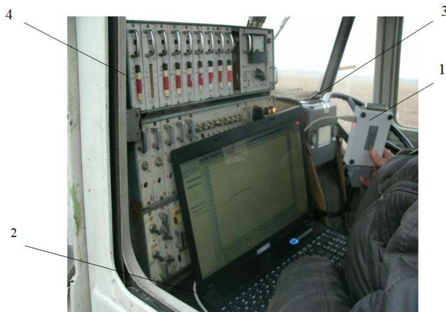
Рисунок 3.2. Інформаційно-вимірювальна система тензотрактора Т-150К:
