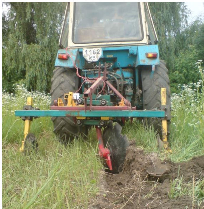
Рисунок 4.3. Тензометрична установка з сферично-дисківим робочим
