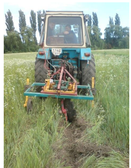
Рисунок 4.5. Тензометрична установка з сферично-дисковим робочим органом та підрізною лапою.
