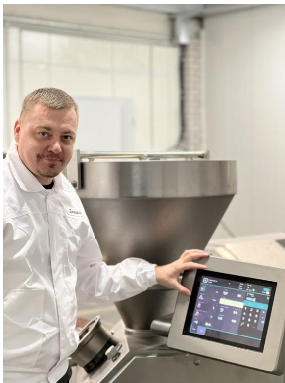
Рис. 6. Шнековий наповнювач, 2800 кг/год
