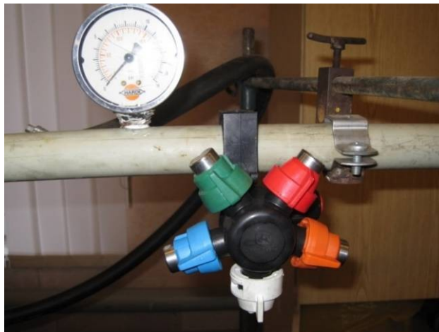
Рис. 3.8. Штанга та розпилююча головка лабораторного станду
