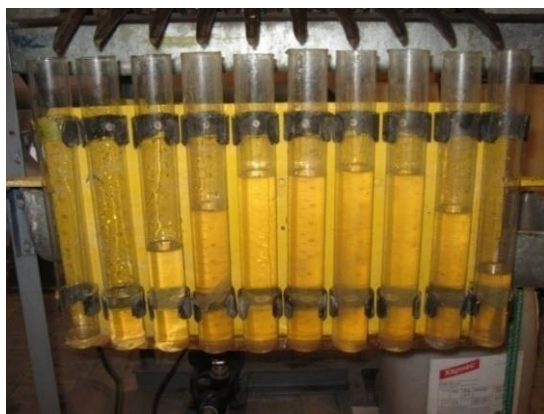
Рис.3.15. Визначення об'ємної витрати рідини через розпилювач
