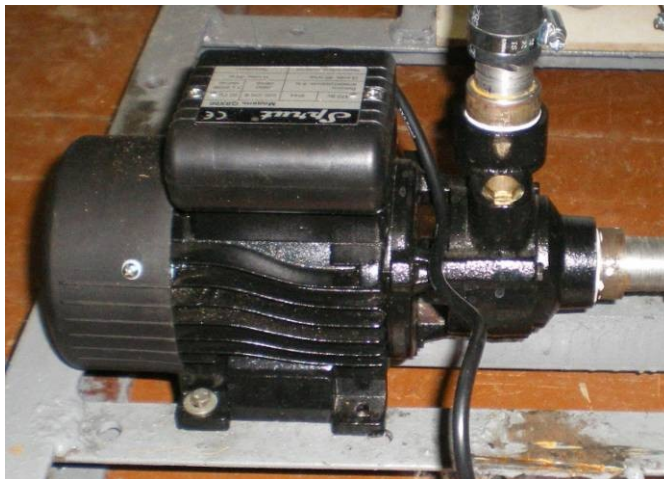
Рис. 3.4. Загальний вид малогабаритного відцентрового насоса QBX60
