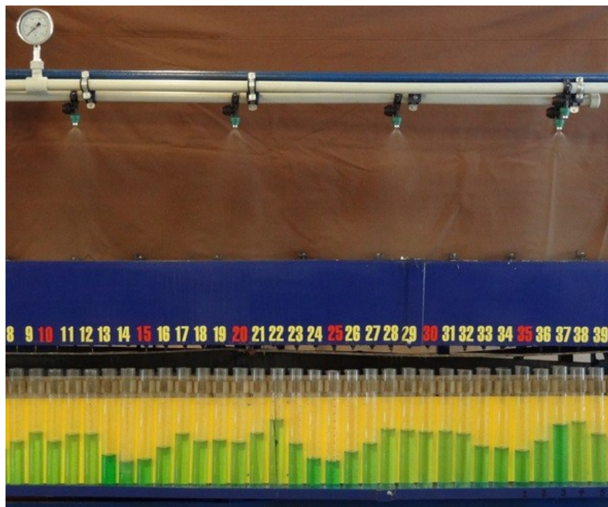
Рис. 4.7. Фото гідралічного стенду під час дослідження рівномірності розподілу рідини по довжині штанги
