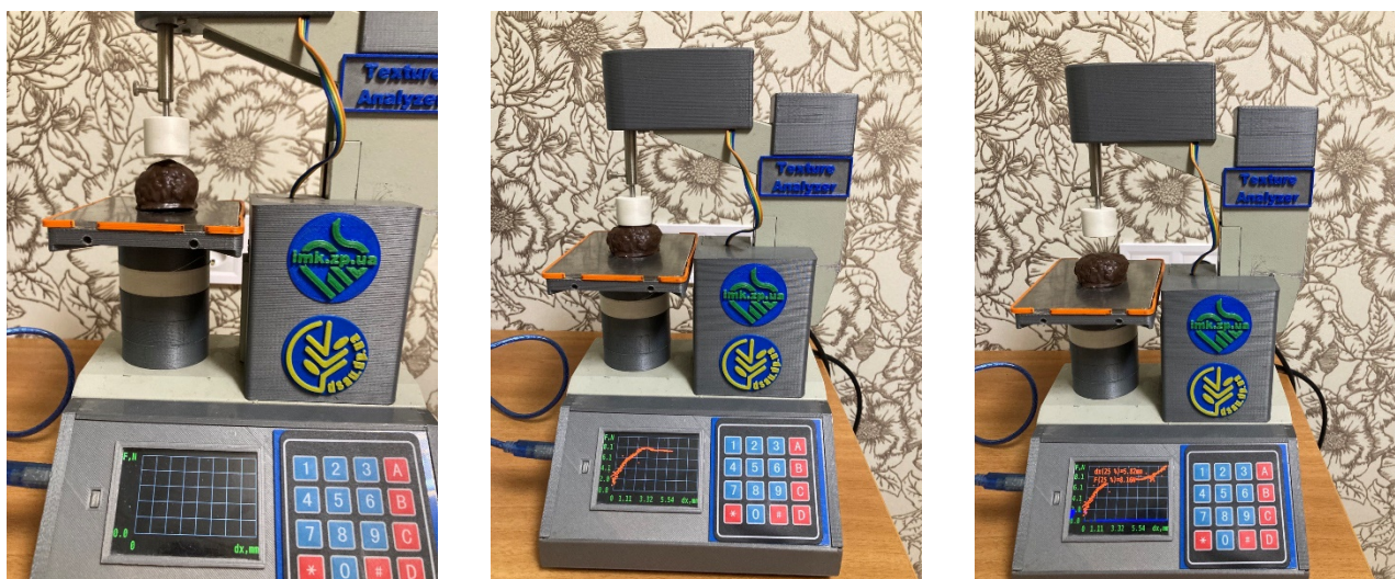
Рисунок 2.6 – Процедура визначення структурно-механічних властивостей дослідних зразків грильяжних цукерок
