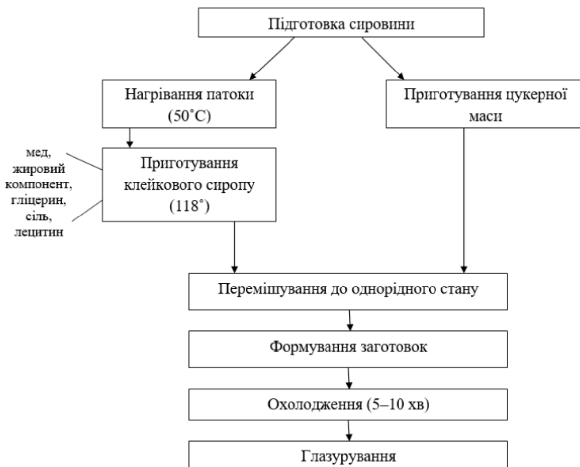
Рисунок 2.5 – Структурна схема виробництва дослідних зразків грильяжних цукерок
