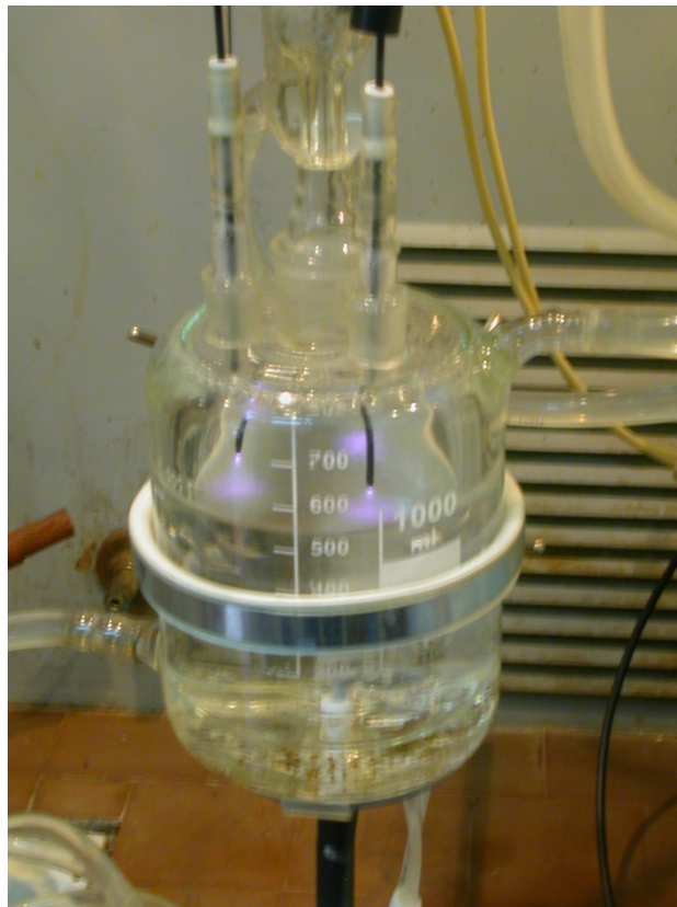
Рисунок 2.3 – Трьохдугвий реактор для виробництва контактої нерівноважної низькотемпературної плазми
