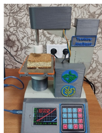
Рисунок 2.5 – Процедура визначення структурно-механічних властивостей дослідних зразків бісквітних напівфабрикатів: а – контрольний зразок; б – дослідний зразок №12
