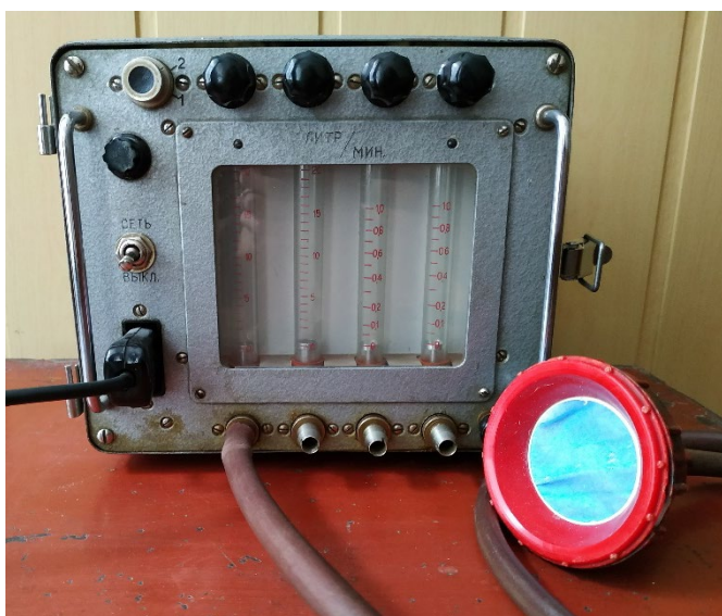
Рисунок 4.1 – Установа для взяття проби запиленого повітря
