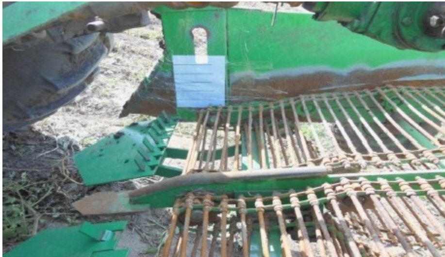
Рисунок 3.4 – Загальний вид вимірювальної шкали для фіксації висоти піднімання картопляного вороху.
