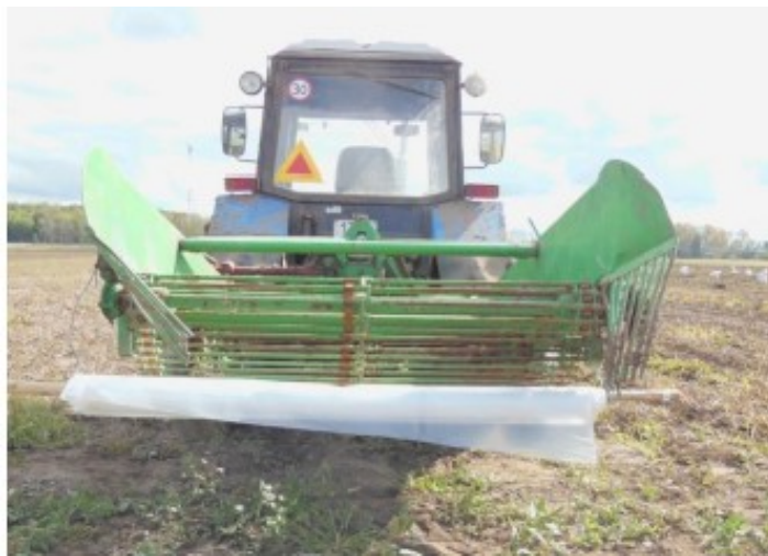
Рисунок 4.4 - Удосконалений картоплекопач КТН-2В під час визначення повноти збирання (вид ззаду)
