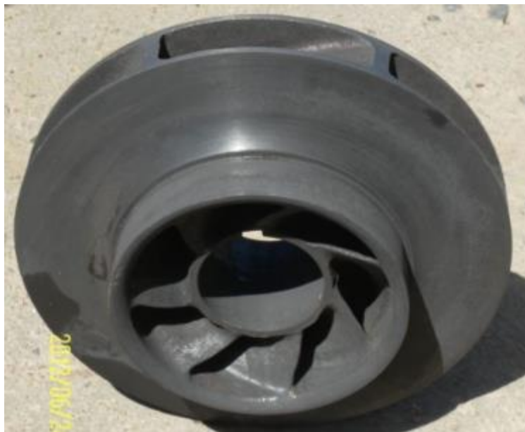
б - робоче колесо сталеве після борирування, твердість – 53HRC, глибина шару – 0,3 мм
