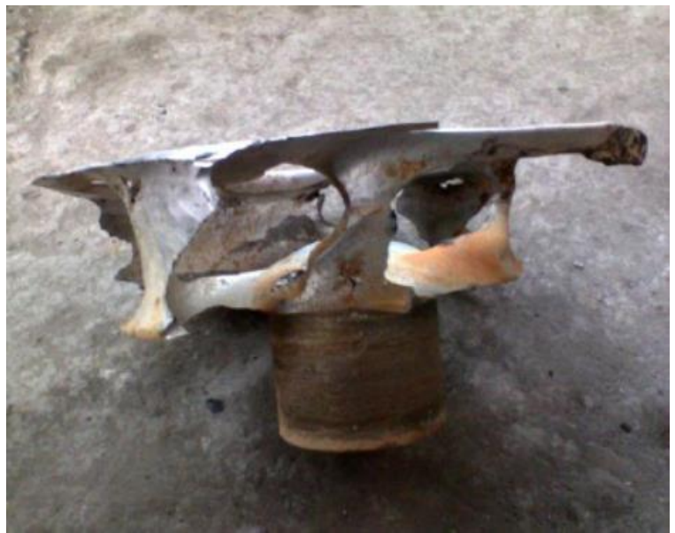
Гідроабразивний знос робочого колеса
