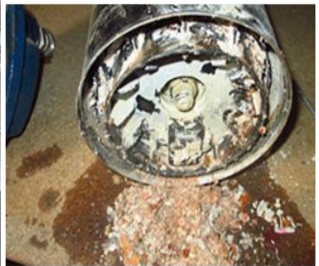
Рис. 1.9. Засмічення та вапнування насосу
