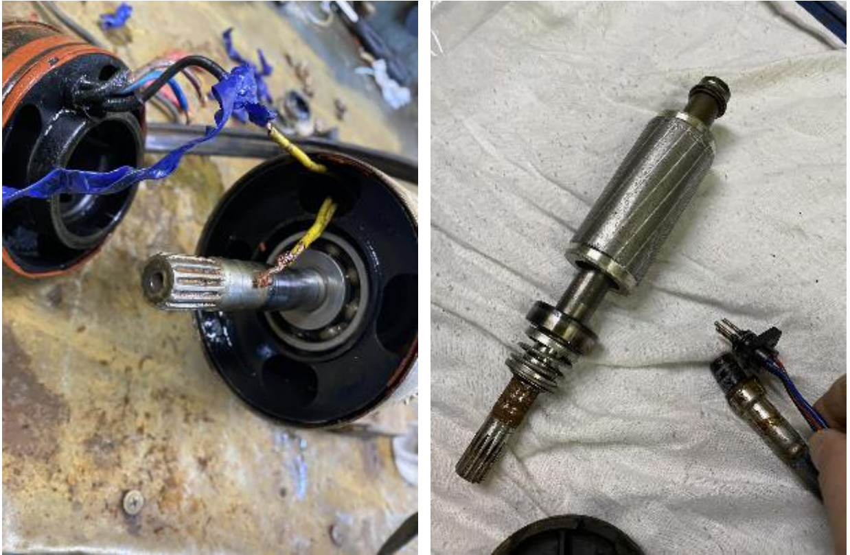
Рис. 1.14. Відмови електричної частини насосу
