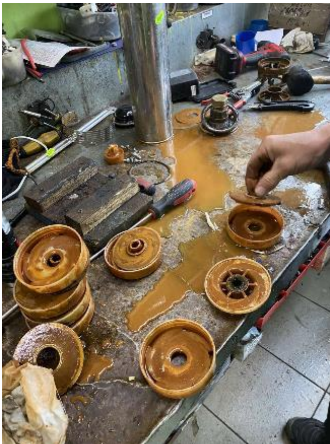
Рис. 1.9. Засмічення та вапнування насосу
