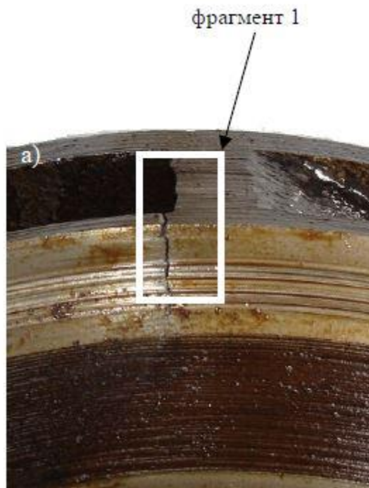
Рис. 3.1- Тріщина на диску робочого колеса
