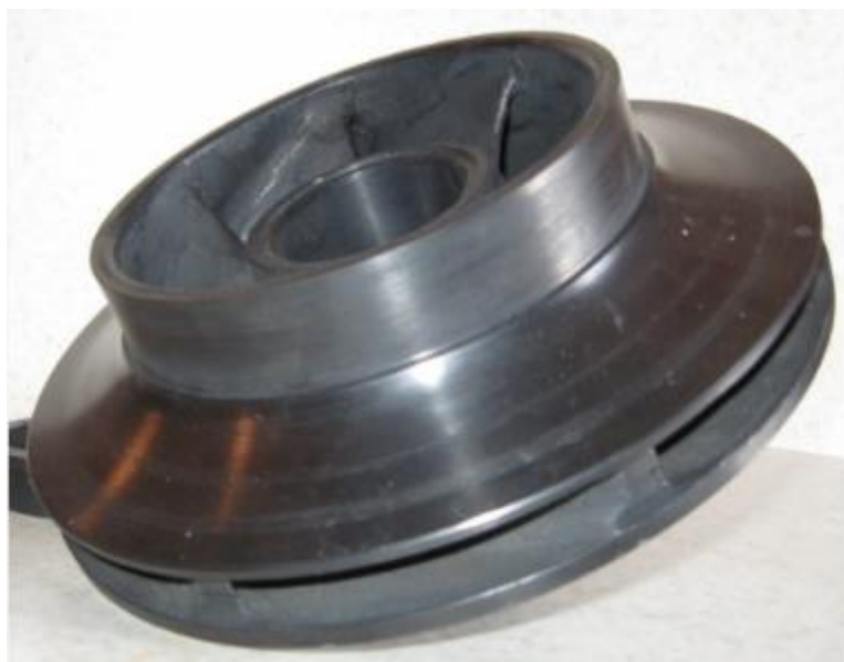
а – робоче колесо сталеве після борирування, твердість – 450HV, глибина шару – 0,31 мм
