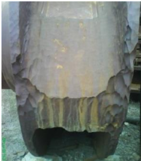
Гідроабразивний знос робочого колеса
