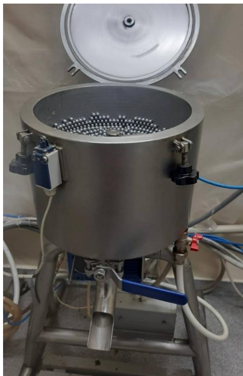
Рисунок 5.2 – Загальний вигляд мікромлина, встановленого в лабораторії на діелектричній підлозі та відповідно заземленим
