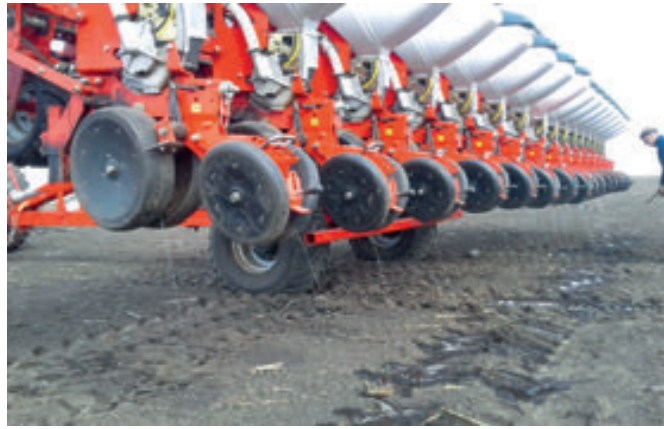
Рис. 13. Перевірка розрахункової дози внесення РКД на сівалці
