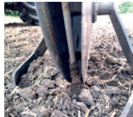
Рис. 15. Аплікатор для внесення РКД разом з сівбою насіння
