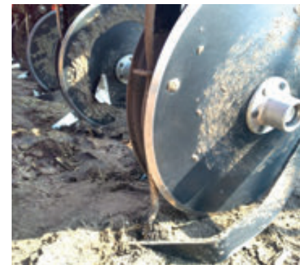
Рис. 17. Підведення РКД до дискового сошника сівалки
