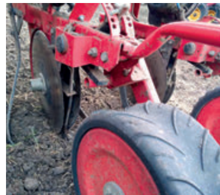
Рис. 16. Робочі органи сівалки з рядковим внесенням РКД
