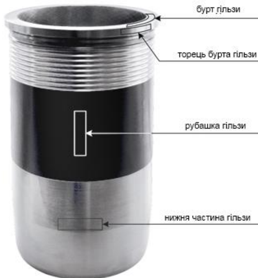
Рис. 1.3. Маркування гільз циліндрів
