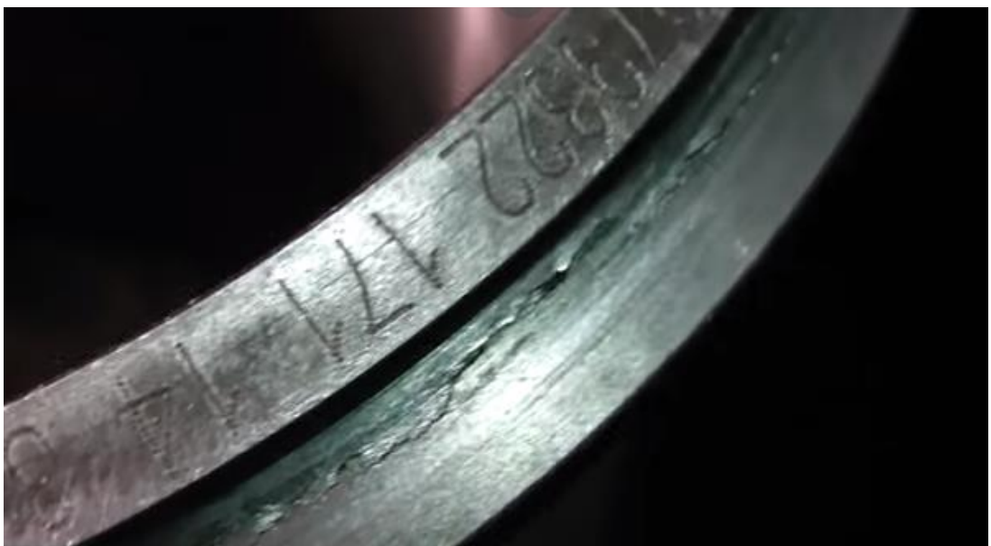
Рис. 1.7. Знос посадкових поясків
