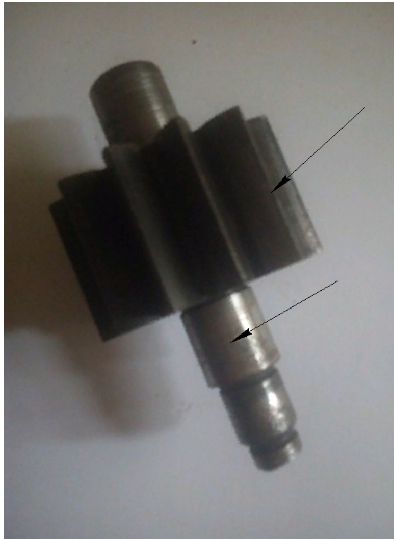
Рисунок 4.4 – Гідроабразивне зношення цапф та зуба ведучої шестерні
