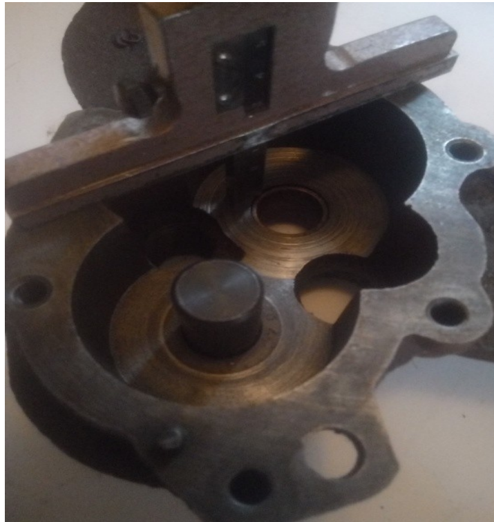
Рисунок 3.4 – Замірювання колодязя корпусу насоса по висоті
