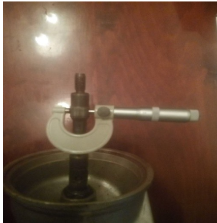
Рисунок 3.5 – Замірювання діаметру посадкових поверхонь на вісі ротора
