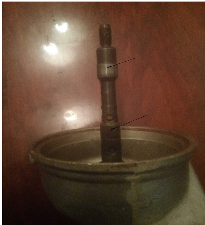
Рисунок 4.5 – Гідроабразивне зношення шийок вісі ротора
