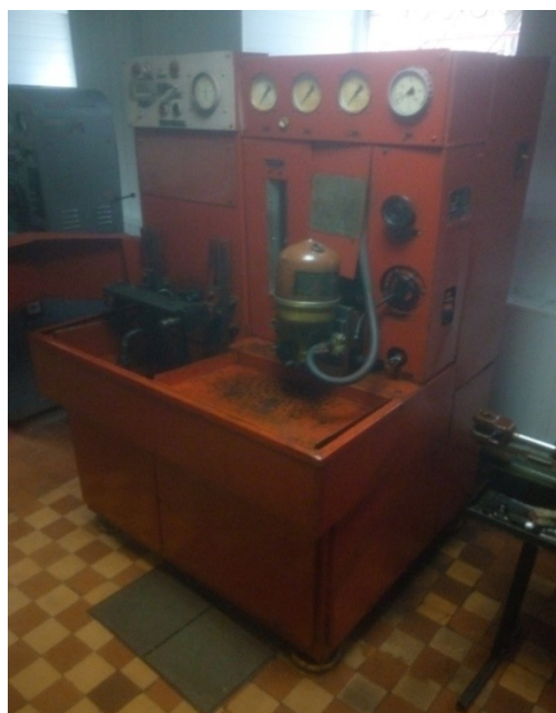
Рисунок 3.6 – Загальний вид стенда КИ-5278 для обкатки та випробовування вузлів системи мащення двигунів внутрішнього згорання
