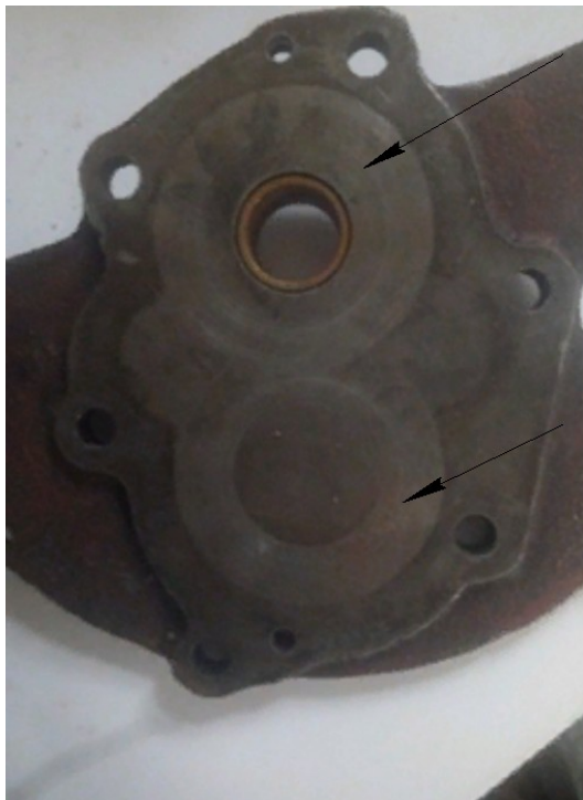
Рисунок 4.3 – Гідроабразивне зношення робочої поверхні кришки насоса
