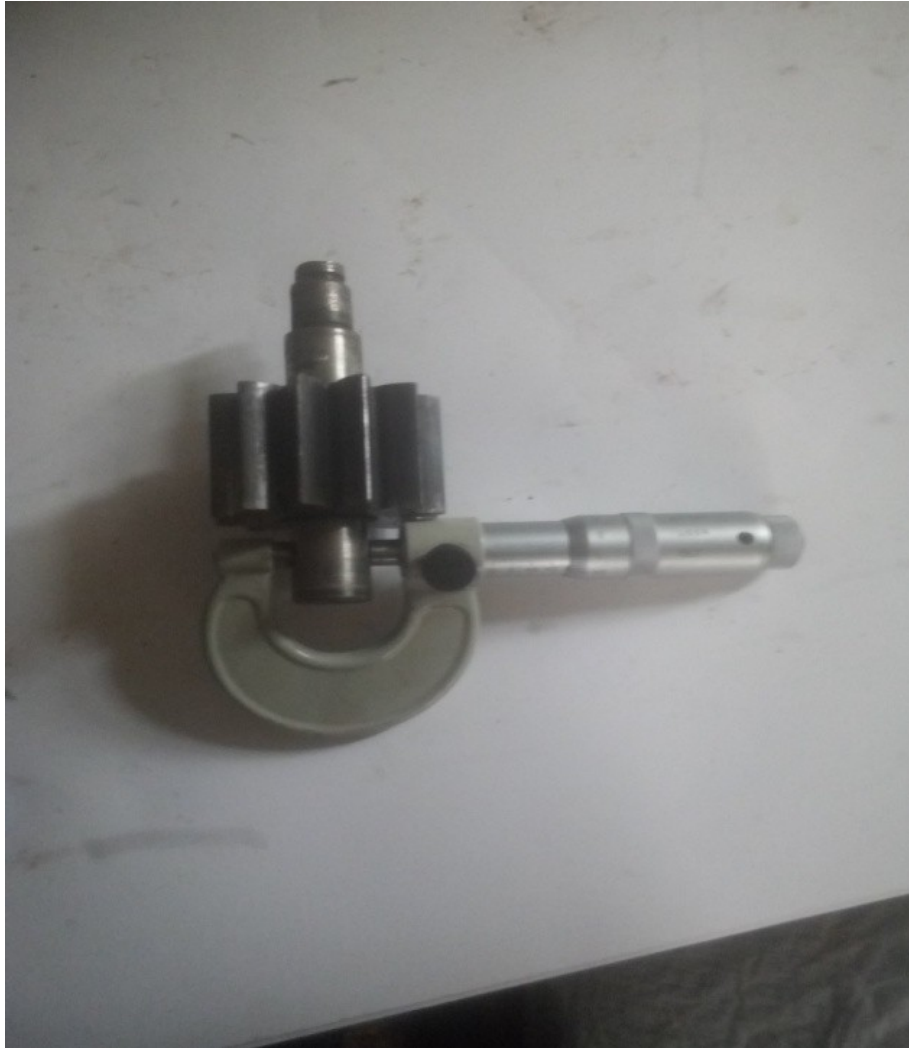
Рисунок 3.3 – Замірювання діаметра цапф валів шестерень
