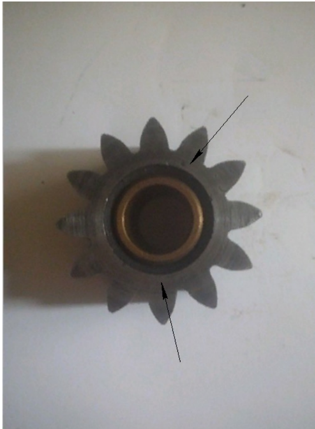
Рисунок 4.2 – Характерне гідроабразивне зношування торцевої поверхні веденої шестерні насоса
