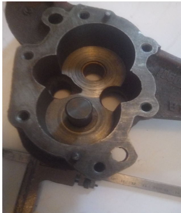
Рисунок 4.1 – Гідроабразивне зношення колодязя корпусу насоса
