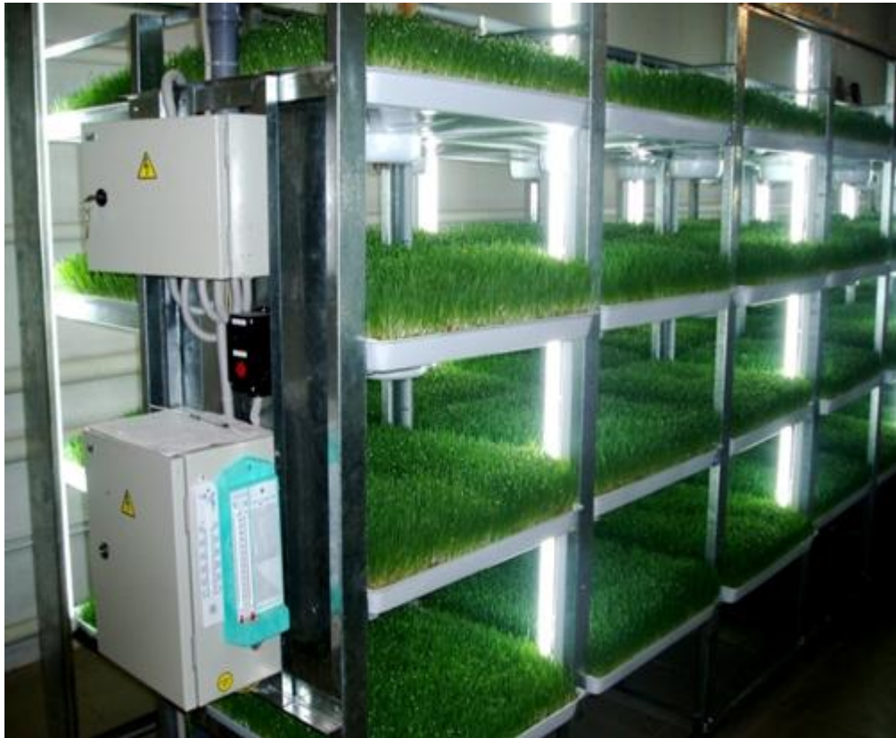
Рис. 3.2 Устаткування для вирощування мікрозелені на основі гідропоніки
