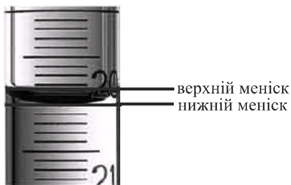
Рис. 13. Зчитування показання об’єму рідини проводять за нижнім меніском
