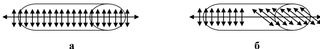
Рис. 32. Проходження поляризованого променя через оптично неактивну речовину (а);
