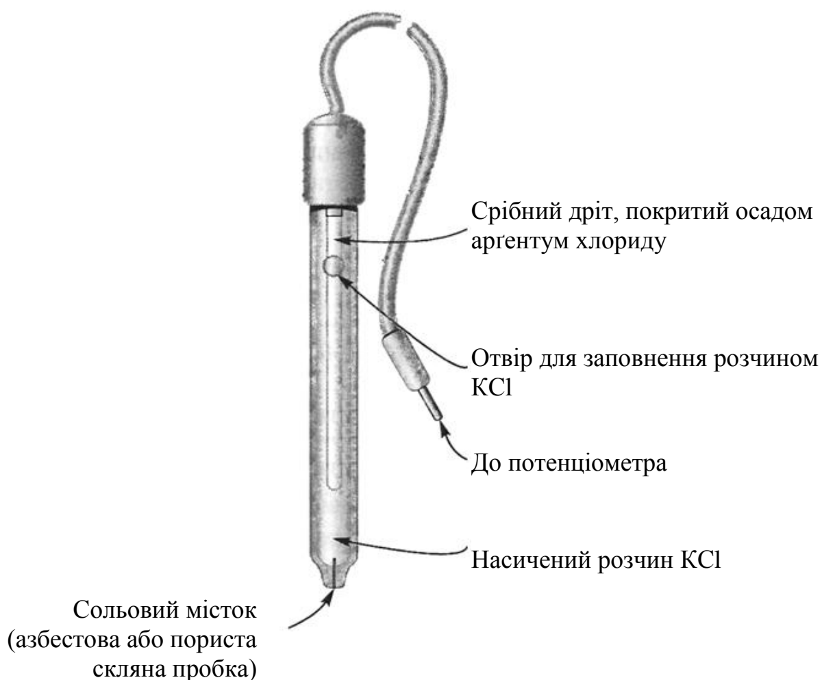
Рис. 6. Конструкція хлоридсрібного електрода
