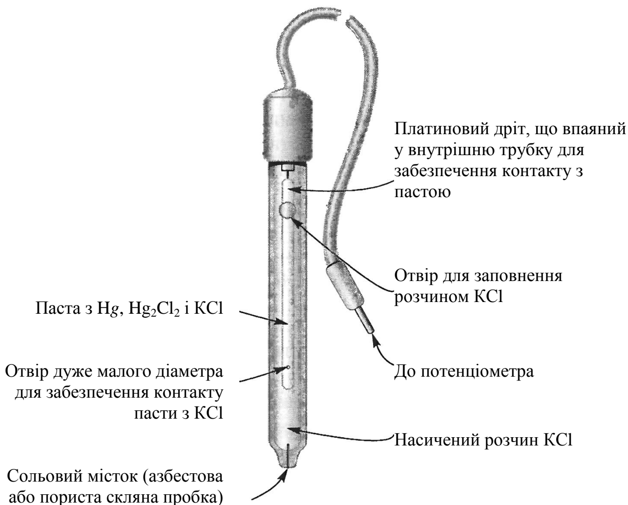
Рис. 5. Конструкція насиченого каломельного електрода
