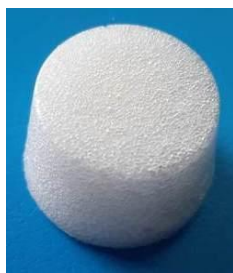
Рис. 1. Дрібнопористий композиційний матеріал на основі ізоціануратвмісних ППУС з 1 мас. % ДК
