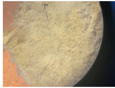
Рис. 2. Оптична мікроскопія: полімер фторопласт 42л (а), шар модифікатору: фторопласт 42л – ГФЦ, іоніт осаджено на шар полімеру (б)
