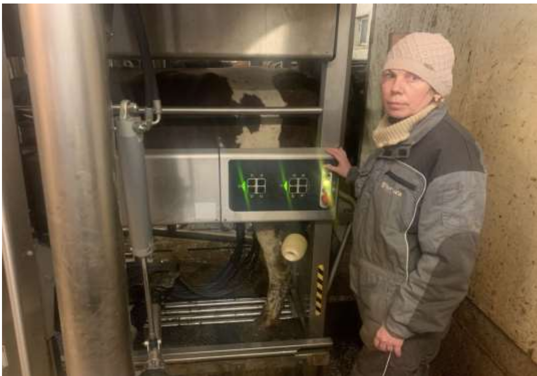
Фото 1. Технологія доїння корів – робот-дояр типу DeLaval VMS TM 310, фермерське господарство Івер Тільдум місто Хьойланнет Норвегія.
