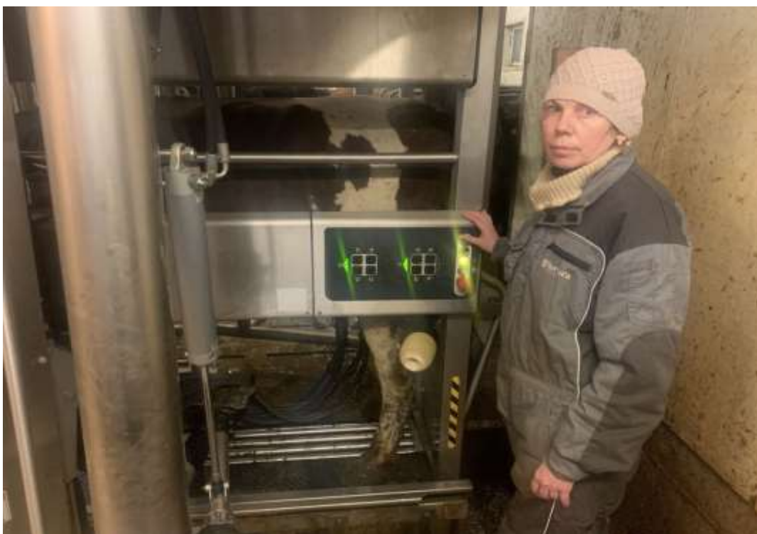
Фото 1. Технологія доїння корів – робот-дояр типу DeLaval VMS™ 310, фермерське господарство Івер Тільдум місто Хьойланнет Норвегія.
