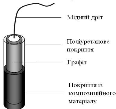
Рис. 1 – Схема конструкції потенціометричного електрода
