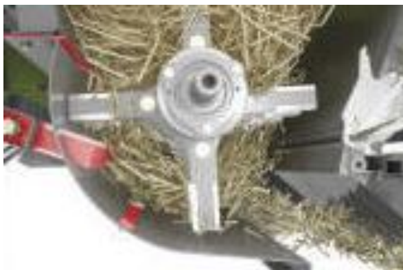
Рис. 2.8.- Подрібнювач-розподілювач SPECIAL CUT зернозбирального комбайна CLAAS TUCANO
