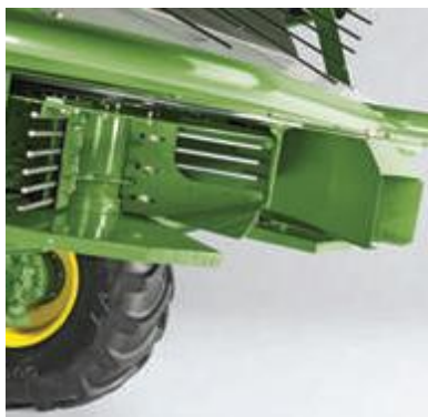
Рис. 2.7.- Подрібнювач-розподілювач Power Cast зернозбирального комбайна John Deere
