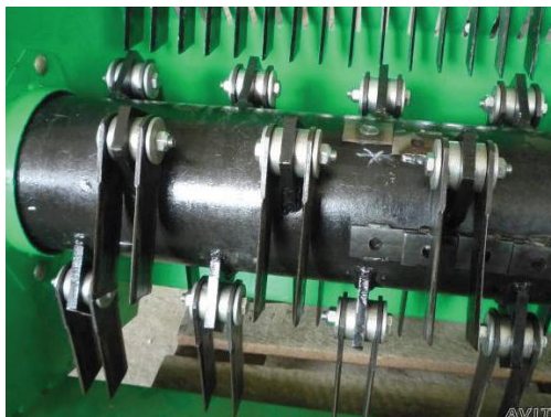
Рис. 2.5.- Подрібнювач-розподілювач зернозбирального комбайна “Дон-1500”
