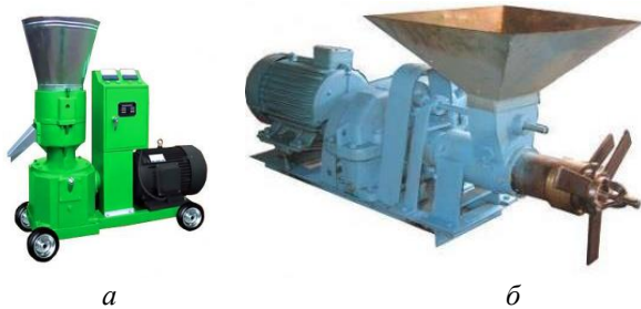
Рис. 3.24. Прес-гранулятори кормів: а – матричного типу; б – шнекового типу
