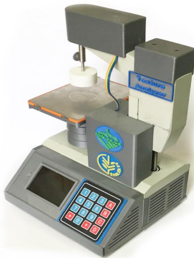
Рис. 4.4. Загальний вигляд пристрою для автоматичного визначення структурно-механічних властивостей харчових продуктів і кормів
