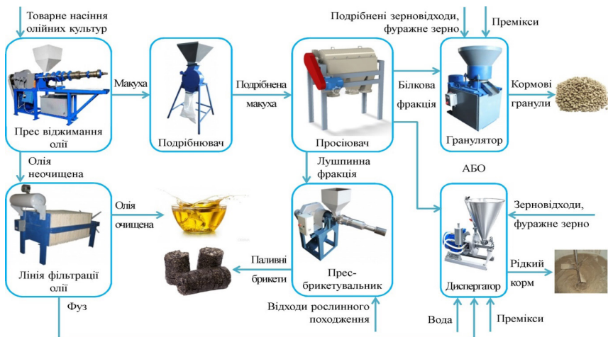
Рис. 2.3. Удосконалена технологічна лінія комплексної безвідходної переробки рослинної сировини олійних культур у корми для органічного тваринництва
