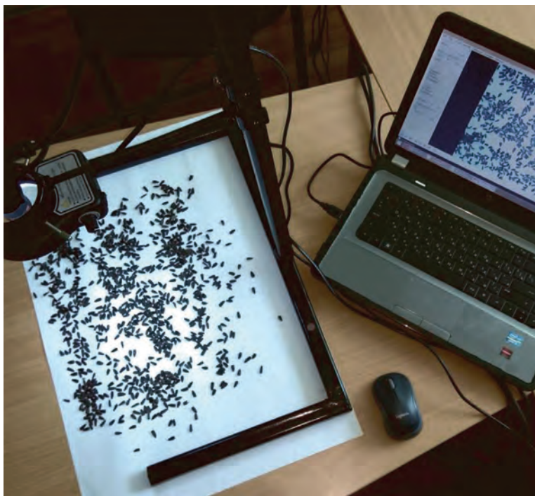
Рис. 3.3. Загальний вигляд спеціалізованого штатива із фотокамерою ELP-USBFHD01M-BFV і джерелом світла
