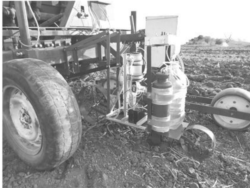
Рисунок 1.4 – Виробничі випробування секції експериментальної сівалки ГПСТВ та Клен-1,8 [2]
