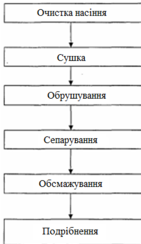
Рисунок 3.1 – Технологічна схема виробництва ядра соняшника
