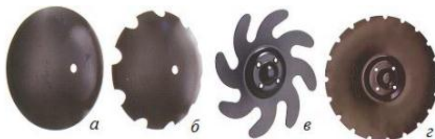
Рис. 3.3. - Типи робочих органів дискових знарядь:
