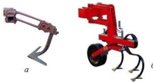
Рис. 3.5. - Паралелограмні підвіски робочих органів культиваторів: а – пружинна; б – повідкова.
