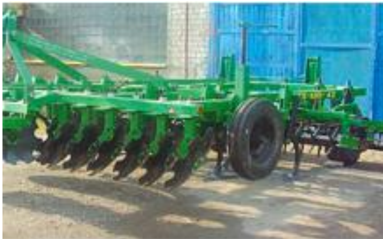
Рис. 2.8. - Агрегат комбінований ґрунтообробний для безвідвального обробітку ґрунту АгроКРП-4,2
