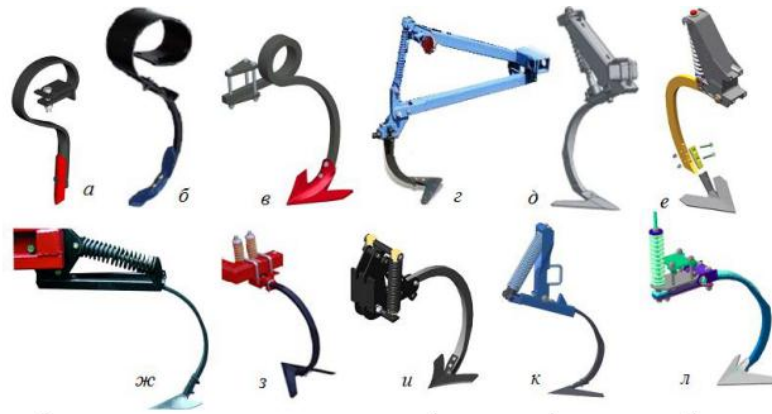
Рис. 3.4. - Радіальні підвіски робочих органів культиваторів а, б, в – пружинні; г – поводкові (грядильні) з пружиною; д, е, ж, л – консольні з пружинами стискання; з, и, к – з пружинами розтягування. Поводкові підвіски найчастіше оснащуються пружинними запобіжниками, з використанням пружин стиснення або розтягування.
