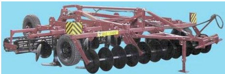
Рис. 2.6. - Універсальний комбінований напівнавісний агрегат ЛКП-4.4
