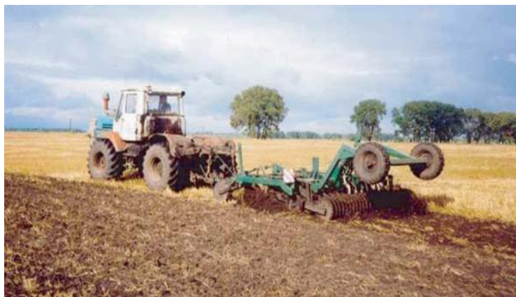
Рис. 2.9. - Агрегат на базі чизельного культиватора КШН-3 у роботі
