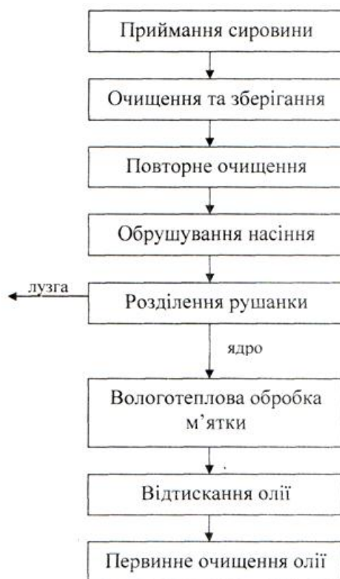
Рисунок 2.1 – Структурна схема виробництва соняшникової олії в СФГ «Іва»
