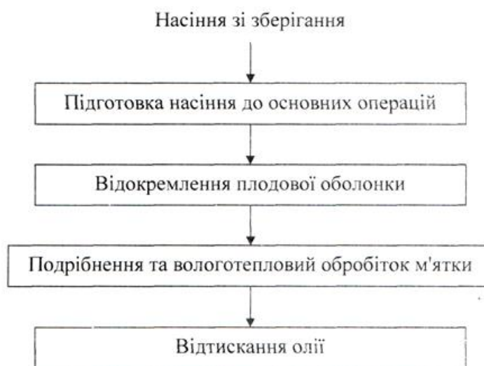
Рисунок 2.2 – Стадії організації технологічного процесу виробництва соняшникової олії у виробничому відділенні
