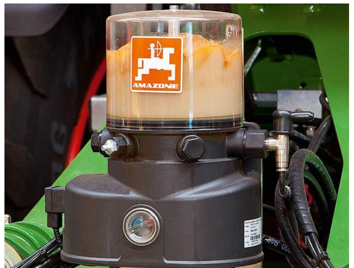
Рисунок 1.5 – Централізована електична система мащення: а – схематичне зображення компонентів системи, б – ємність із мастилом та система розподілення мастила виробництва Amazone
