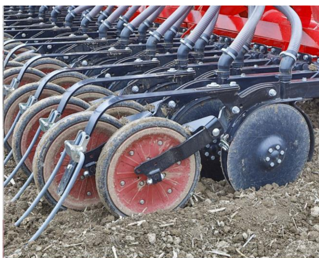
Рисунок 1.1 – Сівалки з радіальними механізмами копіювання без натискних пружин: а – HORSCH Pronto 6 AS; б – Ніка 4М
