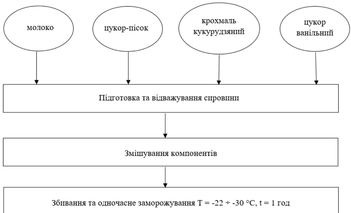
Рисунок 2.2 – Структурна схема виробництва дослідних зразків морозива
