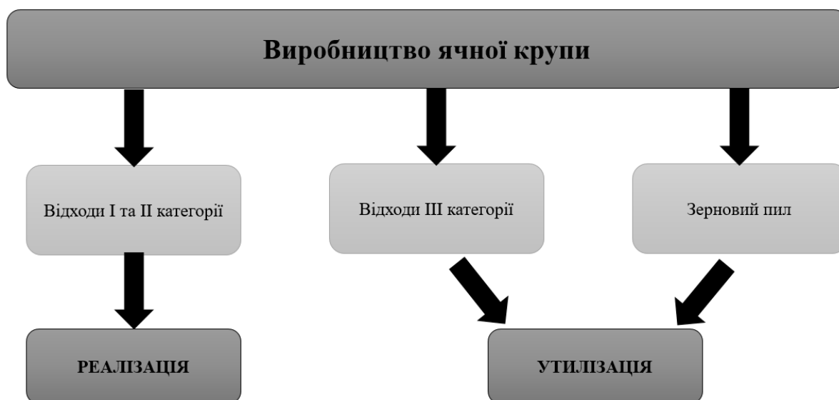
Рисунок 5.2 – Схема утилізації відходів круп'яного виробництва в ТОВ «Стас і К»
